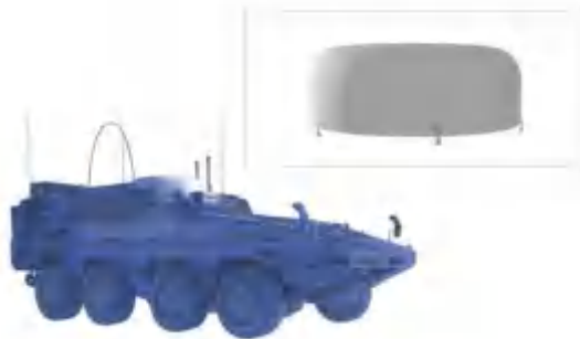
复合材料天线罩（示意图）
